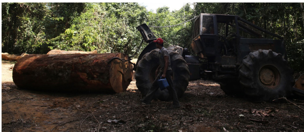
Figura 12. Arrastre de madera con Skidder (Tomado de http://blogs.reuters.com ).
